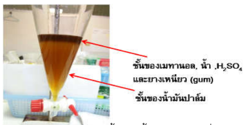
Figure 3 แสดงการแยกชั้นของน้ำมันปาล์มดิบที่ผ่านการลด FAA ด้วยปฏิกิริยาเอสเทอร์ฟิเคชัน
