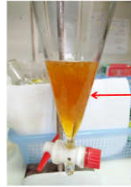
Figure 7 แสดงสารผสมหลังจากปฏิกิริยาการผลิต ไบโอดีเซลสิ้นสุดโดยใช้น้ำมันปาล์มดิบที่ไม่ผ่าน กระบวนการลดกรดไขมันอิสระและยางเหนียวเป็นสาร ตั้งต้น
