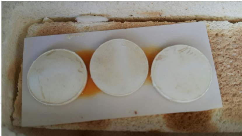
แผ่นเทปจากการเผาผนึก 1175 ° C ความหนา 0.4-0.8 mm
