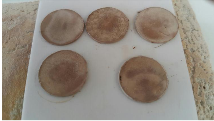
แผ่นเทปจากการอบ 200 ° C
