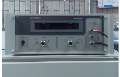
▶ เครื่องจ่ายไฟฟ้ากระแสตรง จำนวน 1 เครื่อง
